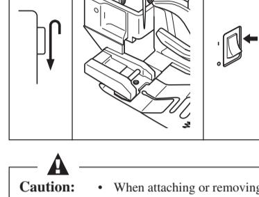
**5. Place the needle in the highest position and turn the power ON.****5. Mettre l'aiguille en position haute et allumer la machine à coudre.****5. Setzen Sie die Nadel in ganz angehobene Stellung, und schalten Sie die Nähmaschine EIN.**
